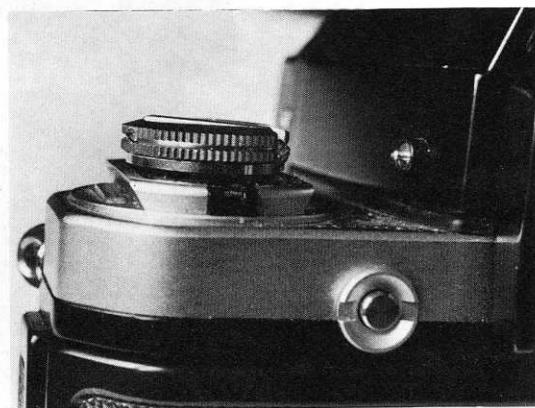
La manivelle de rebobinage est placée sur un sabot porte-accessoires et disposant d'un contact direct pour le flash
