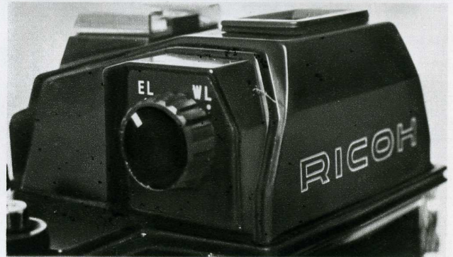
1. Vue arrière sur le viseur. On distingue l'index de système de mesure (sélective ou intégrale). 2. Vue sur le capot du prisme, avec la molette qui, placée sur EL ou WL, permet de changer l'angle de la visée.
