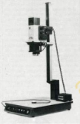
**Fujimoto.** Le G70 Computer comporte une tête de format 6 x 7 à filtrage de 0 à 200 cv, avec système diffusant ou condensant, et une mise au point type microscope (à double mouvement par boutons concentriques). Mais son originalité tient dans la présence d'un compteur précis à 1/10 et d'un analyseur à affichage par diodes. D'où le prix de ce produit prestigieux et très précis : 3 500 F sans objectif.
