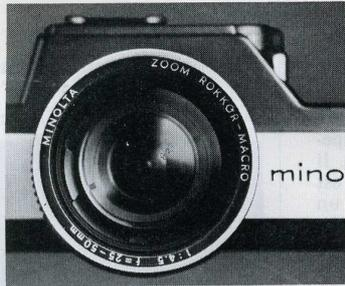
L'objectif est un zoom à 10 lentilles isolées qui varie de 25 à 50 mm (ce qui correspond à un 50-100 mm en 24 x 36). La mise au point se fait de 1 m à l'infini, plus une position macro obtenue par recul de la bague. On peut alors se rapprocher à
