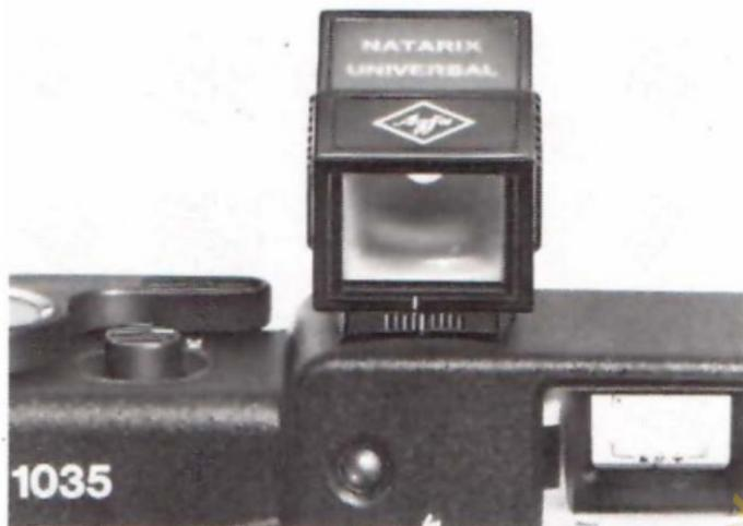
Pour les prises de vues rapprochées à partir de 90 cm, le viseur de l'appareil ne montre plus la partie de l'image exacte. Dans la zone de 70 à 40 cm, le viseur universel Natarix Agfa compense ces parallaxes. Fixer le viseur dans la griffe accessoire et placer le pied pivotant sur le premier trait vers la droite (l'appareil étant orienté vers le sujet). On peut se procurer les bonnettes d'usage courant de
