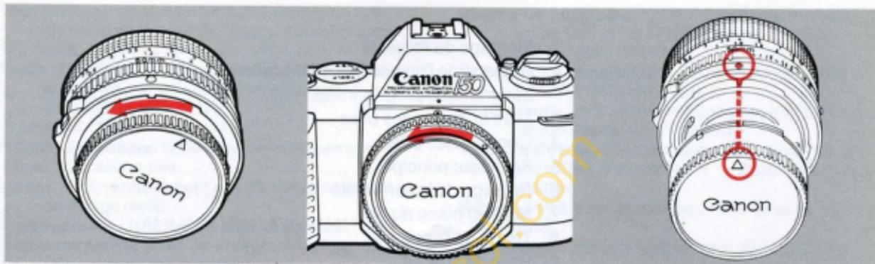
6 Tourner le bouchon arrière à fond dans le sens de la flèche et le retirer de l'objectif.
