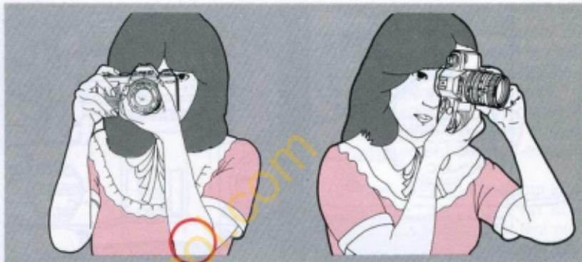
Pendant le déclenchement, le moindre mouvement du corps peut engendrer le flou de bougé. Le meilleur moyen de le prévenir consiste à maintenir l'appareil aussi fermement que possible, la main gauche supportant le boîtier et l'objectif. Appuyer le coude gauche contre le corps, puis serrer l'appareil contre la joue ou le front. En prise de vue verticale, serrer au moins un des deux coudes contre le corps. Ecarter et décaler légèrement les pieds et rester détendu.
