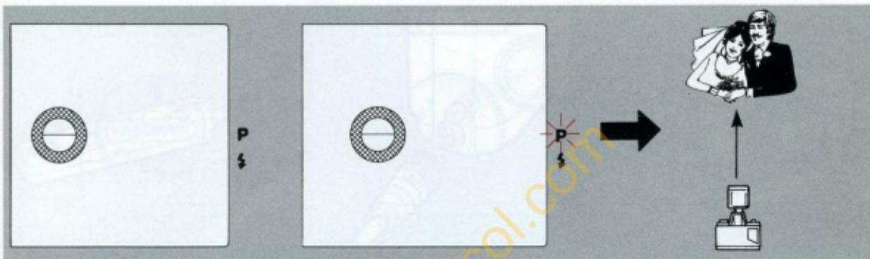
Enfoncer le déclencheur à mi-course; dès que le témoin de charge du flash ( ⚡ ) s'allume, l'appareil est prêt à photographier. Aucun réglage n'est requis. L'ouverture est automatiquement réglée pour obtenir les meilleurs résultats possibles. La vitesse d'obturation, quant à elle, passe automatiquement sur la vitesse de synchronisation X, qui est de 1/60 s.
