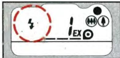
Appuyez sur la touche MODE jusqu'à ce que le panneau ACL affiche le symbole (⚡). Le flash se déclenchera à chaque prise de vue, quelles que soient les conditions de luminosité ambiante.
