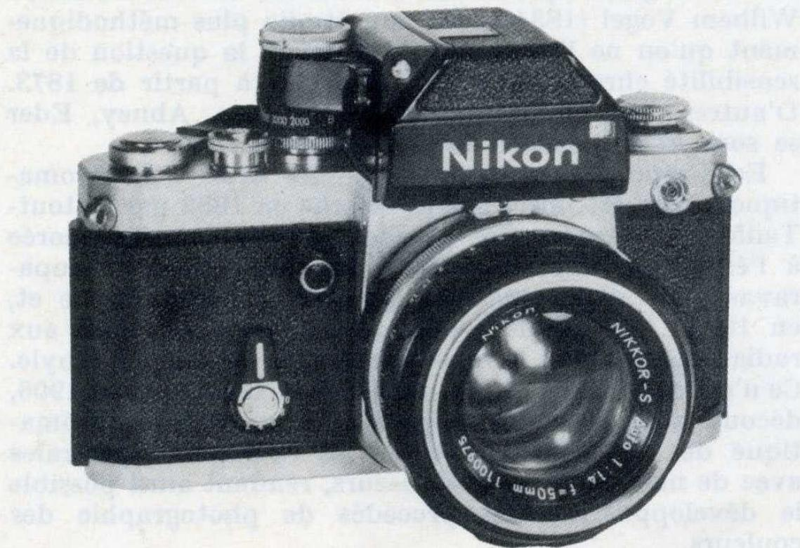
Un contrôle d'armement est visible sur la molette des vitesses. Le levier d'armement a une course très réduite et met automatiquement le Photomic en contact.
