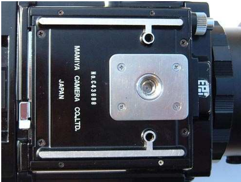
Vue de dessous du boîtier. Le pas de vis est imposant et bien adapté au poids du boîtier.
