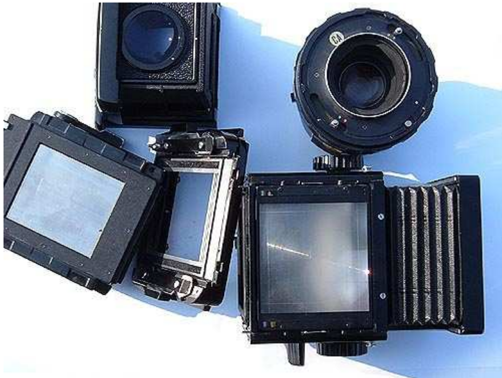
Vue démontée du boîtier. On est ici au coeur d'un véritable système. Toutes les pièces sont interchangeables.
