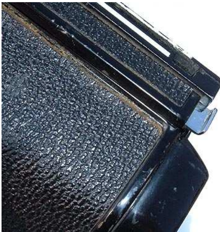
Vue de la petite patte sur le dos amovible qui permet d'ouvrir celui-ci.
