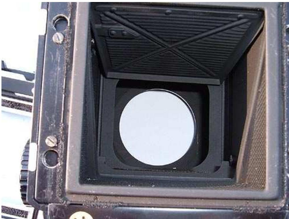
Vue de l'arrière du dos du boîtier désarmé. Le réarmement remet en place le miroir.
