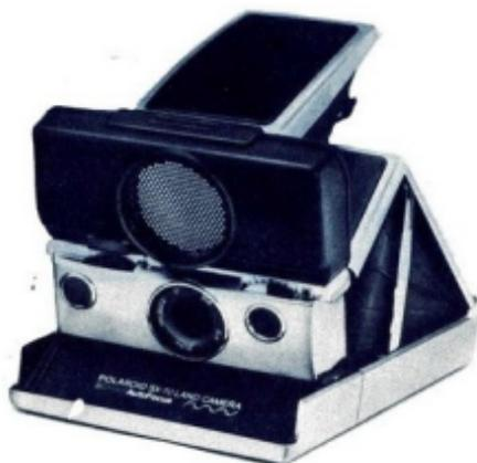
réception de l'écho en fonction de l'éloignement du sujet. Quand la fréquence revient vers l'appareil, un accumulateur transforme le temps obtenu en distance afin de régler automatiquement l'objectif.
