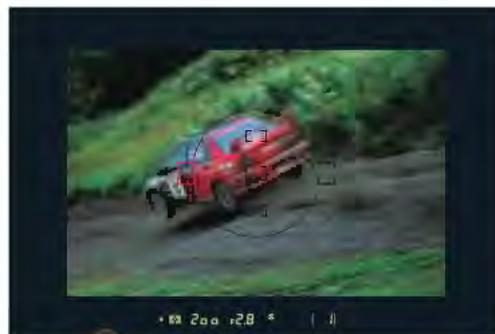
**Dynamique AF:** L'appareil continue de mettre au point sur le sujet en changeant automatiquement de zone de mise au point si celle-ci sort de celle sélectionnée.
