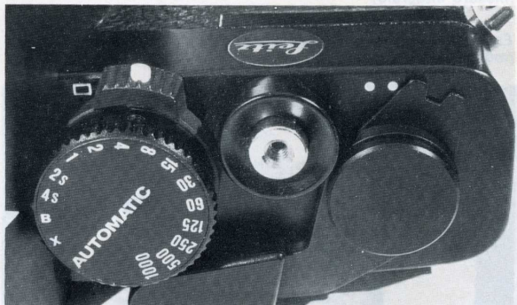
Au-dessus du bouton des vitesses : commande des mesures « spot » et « intégrale ». Au-dessus du levier d'entraînement : commande de la surimpression.
