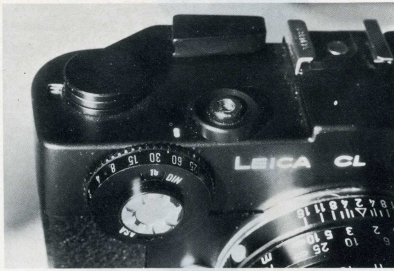
Bouton des vitesses. Au centre, affichage de la sensibilité par pression sur une pastille crantée.
