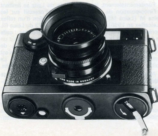
Vue de dessous - de gauche à droite : indicateur de film, bouton de débrayage, clef de fermeture avec écrou de pied au centre, manivelle de rembobinage.
