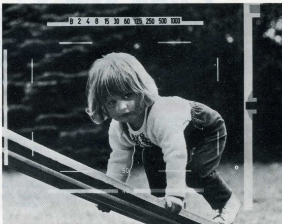
Dans le viseur apparaissent les cadres lumineux correspondant à la focale de l'objectif utilisé 40 et 50 ou 90 mm, ainsi que la plage de mise au point (au centre), la vitesse choisie en haut, l'aiguille du posemètre à droite. Test de pile en haut.
