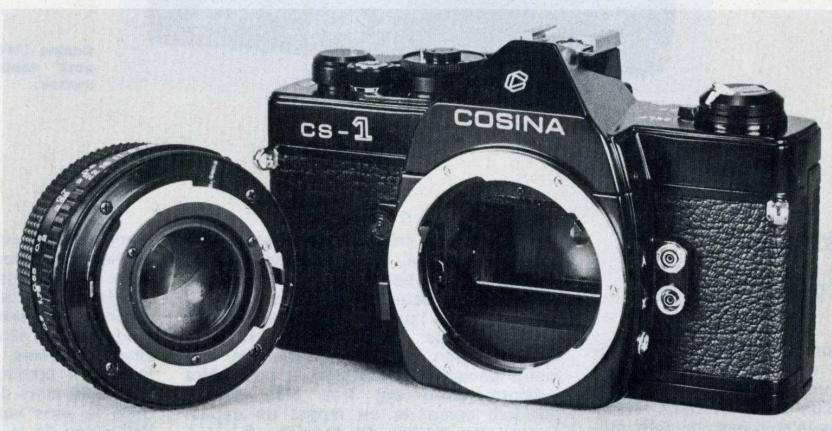
Après retrait de l'objectif, on voit la baïonnette K de fixation des optiques.
