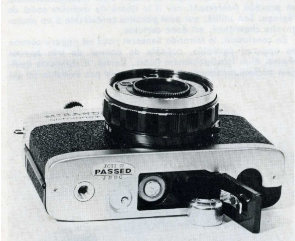
Le logement des deux piles
