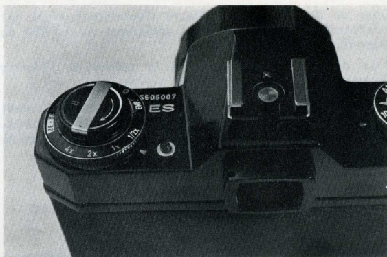
Sous la manivelle de rebovinage, la commande de correction automatique du travail de la cellule (correction de + 2 à - 1 diaphragme).
