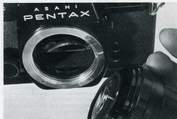
La platine porte-objectif. A droite, les deux prises de flash.
