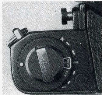
Au tour de la molette de sélection de sensibilité, on voit des repères de correction d'exposition ( \pm 2 diaphragmes au moins et selon la sensibilité affichée jusqu'à deux diaphragmes). Cette large gamme de correction est utile lorsque l'on utilise de très longues focales.
