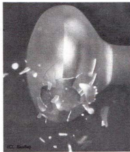
● Cet éclatement d'une ampoule électrique a été photographié à l'aide d'une lampe éclair électronique.
