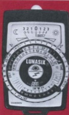
**Gossen.** La Lunasix F permet la mesure incidente ou réfléchie de la lumière continue et celle du flash. Les diaphragmes vont de f/0,7 à f/128 et les sensibilités de film de 0,8/0° à 100 000/51° ISO ! Héritière de la lignée des Lunasix d'une légendaire précision et robustesse, elle en accepte les cinq compléments optiques : additif télé (30°, 15° et 7,5°), additif microscopique, additif de repro, additif Lab et sonde de mesure Ø 5 mm. Sa dernière performance est son prix : 1695 F.
