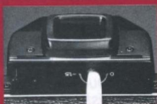
La vis de réglage des viseurs FA-1 et FA-2 déplace un doublet achromatique (de -1,5 à 0 dioptries) tandis que l'étanchéité est assurée par une glace à faces parallèles. Sur le prisme FA-1W, la correction dioptrique est plus étendue (-3 à +1 dioptries) grâce à un système à 4 lentilles, sorte de zoom rudimentaire.
