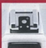
**La griffe** porte-accessoires transmet outre la synchronisation, l'automatisme TTL avec le flash SB 15, grâce à ses trois contacts supplémentaires. La vitesse est commutée dès le début de la recharge sur 1/90 s, et la DEL de flash s'allume en fin de recyclage. Cette DEL sert aussi de témoin TTL de sous-exposition.
