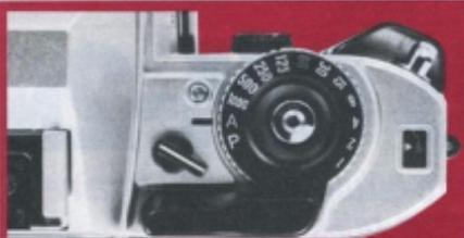
**Le barillet des vitesses** est encliqueté sur A et P. Tant que la vue n° 1 n'est pas atteinte, l'obturateur fonctionne à la vitesse mécanique de 1/90 s pour ménager les piles. À gauche et en arrière du barillet, le levier de mise en service du buzzeur (vitesses lentes, sur ou sous-exposition).
