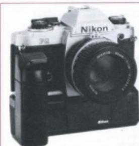
**Le moteur MD-14** possède les cadences de 3,2 et 21/s. Il n'a pas de vue par vue individualisée ni de déclencheur propre. Le déclenchement s'effectuant à partir de celui du boîtier, il est coupé automatiquement en fin de film, rappelé par DEL au dos. Alimenté par 8 piles 1,5 V, son prix est avantageux et sa poignée est très pratique.
