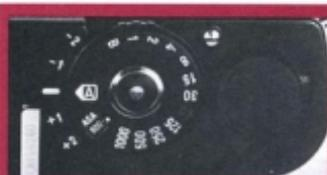
**Le barillet des vitesses encliqueté sur A**, sert de correcteur d'exposition et de sélecteur de sensibilité (25 à 1600 ISO). Les vitesses manuelles sont toutes accessibles, mais elles éteignent toutes les DEL du viseur. Au centre du barillet, la touche sensitive met en fonction le circuit d'automatisme et assure le déclenchement électro-magnétique.
