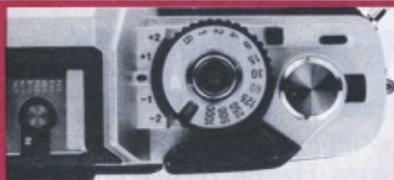
**Le barillet des vitesses** sert de correcteur d'exposition et de sélecteur de sensibilité. Ces deux dernières fonctions sont totalement distinctes. A sa droite, son bouton de verrouillage. En son centre, le déclencheur sensible. Par effleurement (main nue) ou légère pression (main gantée), le circuit d'automatisme est mis en service, et une pression un peu plus forte amorce le cycle de déclenchement.
