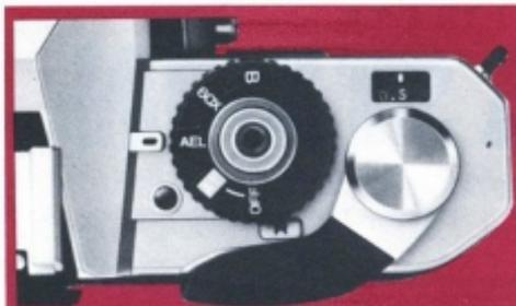
Sur les AX-1 sortis après la Photokina 1982, il existe une position AEL : la mémorisation et est verrouillée lors d'une pression partielle du déclencheur. Pour déverrouiller la mémorisation, il suffit de relâcher le déclencheur : une nouvelle mesure peut alors être effectuée et mémorisée.
