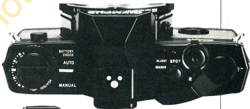
l'unique cellule au silicium logée à la face inférieure de la chambre reflex (système de prélèvement très voisin de celui du Leica R-4). Dans le cas du mode Auto, un bouton de mise en mémoire permanente de l'exposition (fonctionnant donc aussi au moteur, en rafales) vient compléter le système de mesure.
