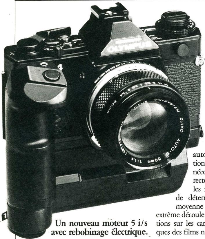
Un nouveau moteur 5 i/s avec rebobinage électrique.
