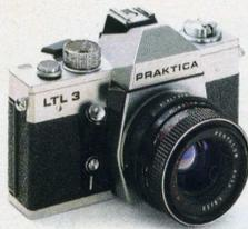
Praktica LTL 3. Reflex 24 x 36 TTL. Il possède tous les perfectionnements qui en font un grand reflex. Sensibilité 25 à 1600 ASA. Vitesse de 1 à 1/1000<sup>e</sup> de sec. + pose B. Obturateur vertical à lamelles métalliques. Synchro flash au 1/125<sup>e</sup> de sec. Retardateur. Objectif vissant Ø 42 aux normes internationales.
