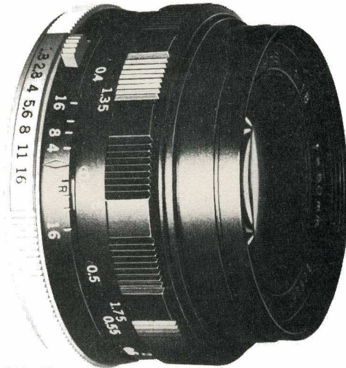
Objectif standard F/1.8 de 50 mm F Zuiko Auto S 6 éléments en 5 groupes
