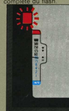
LED clignotant pour indiquer l'exposition correcte au flash.
