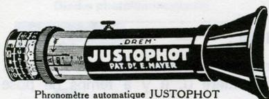
LE JUSTOPHOT – une des réalisations les plus évoluées de ce principe de posemètre avec oculaire à mise au point.
