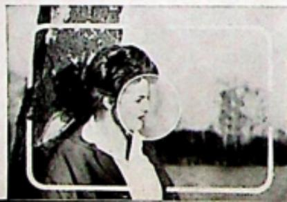
Pour les objets en mouvement, réglez d'abord une distance supposée sur l'échelle et laissez l'objet visé s'avancer vers vous. Suivez les mouvements dans le viseur et faites la prise de vue aussitôt que les deux images se recouvrent dans le cercle. Le visier lumineux qui indique exactement le champ de l'image permet de cadrer exactement.
