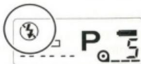
**Appuyer sur la touche de mode flash jusqu'à ce que l'indicateur de mode flash annulé apparaisse sur l'écran de contrôle.**
