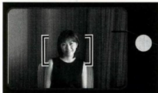
4. Positionner la zone de mise au point (matérialisée dans le viseur par les deux crochets) sur le sujet principal puis appuyer à mi-course sur le déclencheur.
