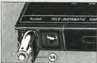
Mise en place de la pile
