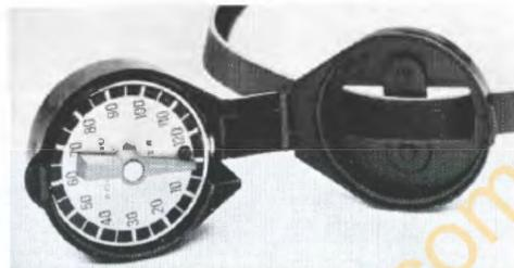
Le compte-temps n° 128 accroché à la courroie, mesure la durée des développements.
