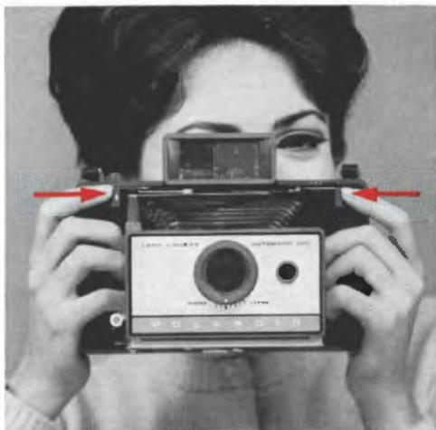
**UN:** Pour mettre au point, regardez quelqu'un à travers le viseur. Placez la ligne supérieure du télémètre sur le haut du front de votre sujet. Exercez-vous à pousser les boutons n°1 afin d'amener la ligne mobile à la base du menton.
