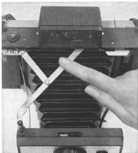
Appuyez sur la barre de verrouillage. Ceci libère l'avant de l'appareil; poussez l'avant jusqu'à ce qu'il se bloque.
