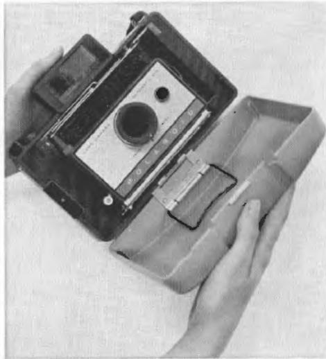
Repliez le couvercle: appuyez sur le dessus dans la partie centrale afin de le fixer sous le viseur.
