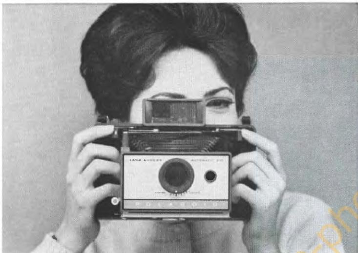
**HORIZONTALEMENT:** Tenez fermement les deux extrémités. Placez vos index sur les boutons n° 1; vous pouvez facilement déplacer l'index droit vers le bouton n° 2. Pour caler l'appareil, serrez les coudes au corps, appuyez l'appareil sur votre nez.
