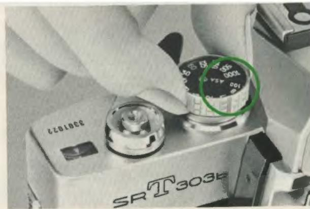
Relâcher la bague; elle se déroule automatiquement. Les points placés entre les chiffres correspondent aux indices ASA suivants:
