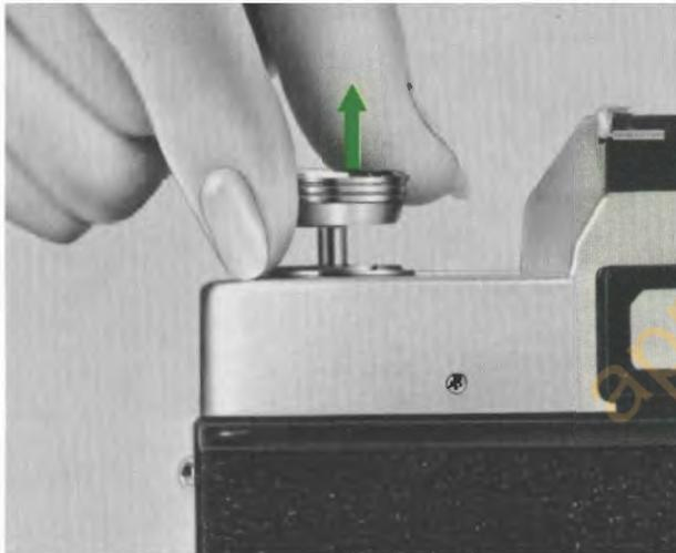
2. En laissant le bouton dans cette position, mettre en place une cartouche de film, la tête de l'axe vers le bas de l'appareil. Repousser à fond le bouton de déblocage vers l'intérieur, en le tournant légèrement si c'est nécessaire.
