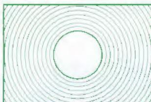
**Type B:** Dépôli de Fresnel avec dépôli fin dans le cercle central de  $\phi 12\text{mm}$ . L'absence de stigmomètre et/ou microprismes aide la visée et la mise au point, en particulier avec les ultra-grands-angulaires et les super-téléobjectifs. Le cercle de  $\phi 12\text{mm}$  correspond à la zone de prépondérance photométrique. Le verre B convient à tous les objectifs, mais plus spécialement aux objectifs à faible ouverture maximale, comme les Reflex-Nikkors, et en photomacrographie.
