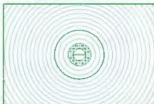
**Type K:** Dépôli de Fresnel avec stigmomètre central horizontal ( $\phi 3\text{mm}$ ) et couronne de microprismes (largeur 1mm). La combinaison stigmomètre/microprismes permet une mise au point rapide et précise, surtout avec les objectifs à grande ouverture maximale. Le cercle repéré de  $\phi 12\text{mm}$  correspond à la zone de prépondérance photométrique. Excellent en photographie générale, le verre K est l'équipement standard de tous les boîtiers Nikon.
