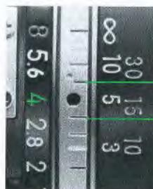
Objectif réglé à  $f/4$ : Sujet principal net, profondeur de champ de part et d'autre faible.
