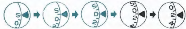
Dos de l'appareil armé 1ère vue à blanc 2e vue à blanc 3e vue à prendre 4e vue à prendre
