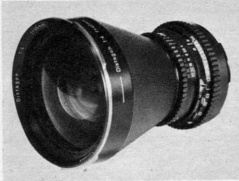
Les ateliers Carl Zeiss à Stuttgart en Allemagne occidentale ont mis au point cet objectif super grand-angulaire pour les appareils reflex mono-objectif Hasselblad employés par les astronautes américains. Composé de dix lentilles groupées en neuf éléments, il possède un angle de champ de 88°, et il est fourni monté dans un obturateur Synchro-Compur, avec diaphragme pré-sélecteur automatique. Il est connu sous le nom : Distagon 1 : 4/40 mm.
