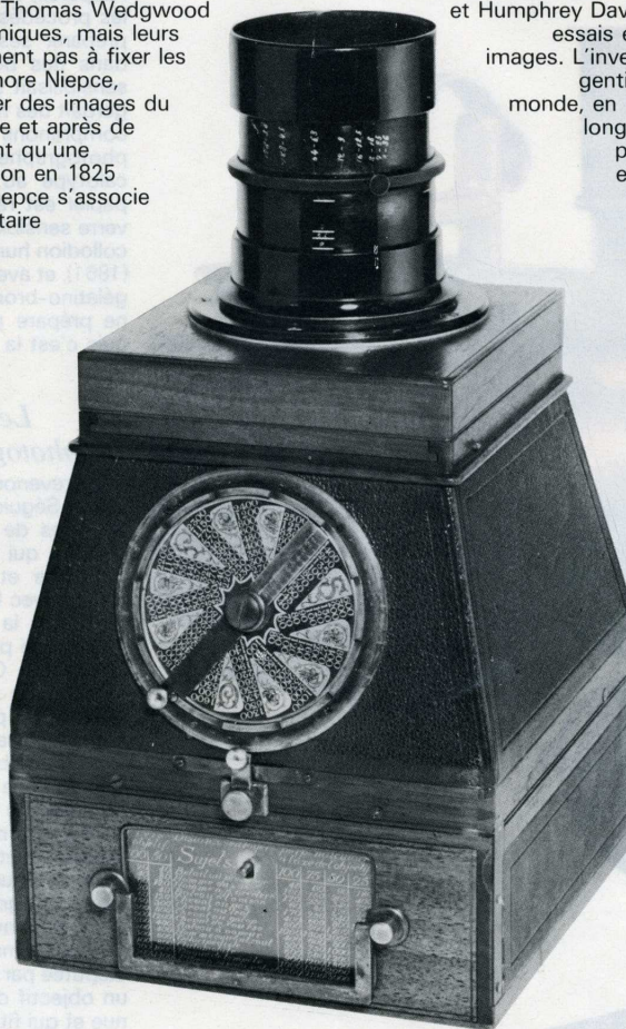
Jumelle Sigriste inventée par le peintre suisse Guido Sigrist pour photographier des chevaux en mouvement.
