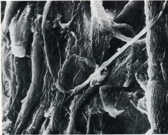
Photographie d'une feuille de papier réalisée au microscope électronique à balayage (800 ×) avec un dos Polaroid mod. 405 sur film positif/négatif Type 105 par E. Richards.
