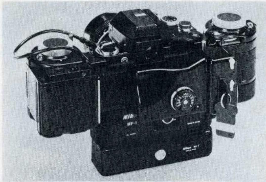
Cet accessoire pour boîtier Nikon surimpressionne sur le côté gauche de chaque image, au moment de l'exposition, l'heure et autres données diverses. Nécessite l'utilisation du moteur MD-1 et du dos-magasin MF-1, à des cadences pouvant aller jusqu'à 3 im/s.
