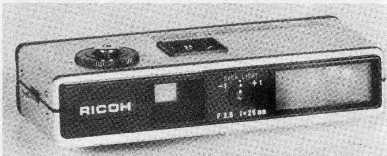
Objectif Rikenon 2,8/25 mm. Mise au point par trois symboles crantés et bonnette. Exposition automatique réglée par diaphragme variable commandé par une cellule CdS. Corrections de  $\pm 1$  diaphragme. Obturateur à deux vitesses 1/30 et 1/250 s. Flash magicube. Viseur avec indications de parallaxe, de symbole de mise au point, d'aiguille de cellule et de magicube utilisé. Accepte des filtres et bonnettes. Dimensions : 125,5 × 58 × 27 mm. Poids : 200 g.
