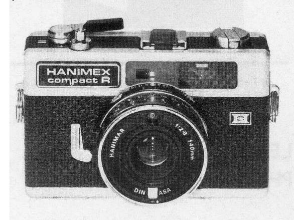
Viseur avec cadre lumineux et correction de parallaxe; objectif Hanimar 2,8/40 mm; 1/8 à 1/500 s et pose B; 25 à 800 ASA; mise au point de 90 cm à l'infini; contact et sabot de flash.
