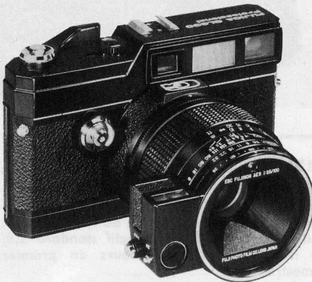
Chambre pour format 6 x 7 cm ; objectifs interchangeables traités EBC (50 à 180 mm) ; obturateur électronique ; vitesses : 8 s à 1/500 s et pose B ; flash X ; exposition automatique commandée par cellule CdS (25 à 800 ASA) ; commande d'exposition manuelle possible ; alimentation par piles de 6 V ; télémètre couplé ; viseur à cadre avec correction de parallaxe pour 100 et 150 mm ; dimensions : 116 x 183 x 145 mm ; poids : 1 830 g avec un objectif.
