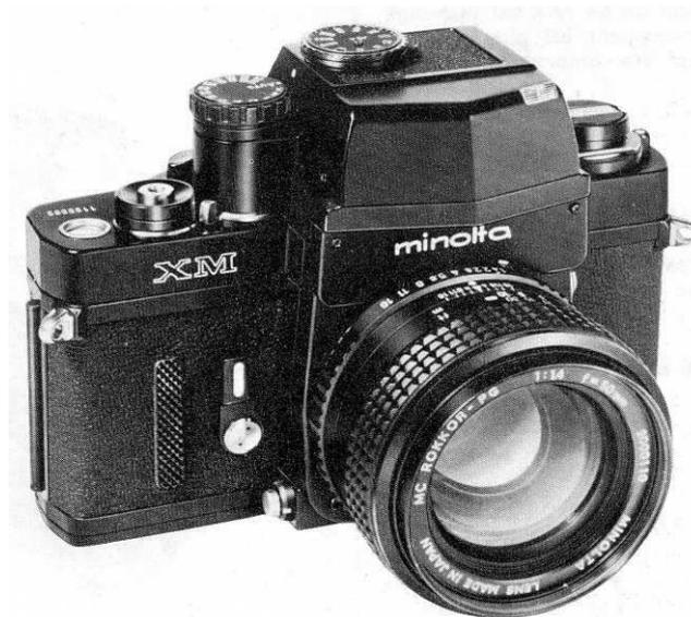
Viseur Auto Finder EE : mesure à pleine ouverture TTL par système CLC à deux cellules CdS. Mesure à diaphragme réel, également possible. Sensibilité de films de 12 à 6400 ASA. Sont visibles dans le viseur : diaphragme, échelle des vitesses, aiguille d'indication de cellule et lampe avertisseur d'exposition.
