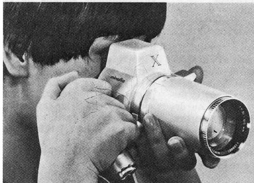
LE PRÉCURSEUR du Minolta 110 Zoom : il avait été créé en 1966 sous le nom de Minolta Electro Zoom X pour un format de film  $12 \times 18$  mm et comportait un obturateur électronique donnant des vitesses de 1/2 au 1/500 s et un zoom de 30 à 120 mm. Ce prototype n'a jamais vu le jour.
