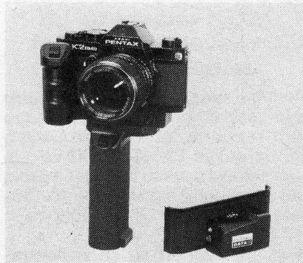
gamme de la série K équipé d'un f/2 de 55 mm SMC-Pentax, et une version spéciale motorisable du K2, le K2-DMD motor drive. Par rapport au K2 normal, quelques modifications : possibilité de motorisation (« of course » !), indication de l'ouverture dans le diaphragme (comme KX), correction d'exposition (1/4 x, 1/2 x, 2 x, et 4 x) rappelée dans le viseur, obturateur d'oculaire, signal de pile faiblissante. En accessoire, des dos grande capacité et des dos-inscripteurs de données.
