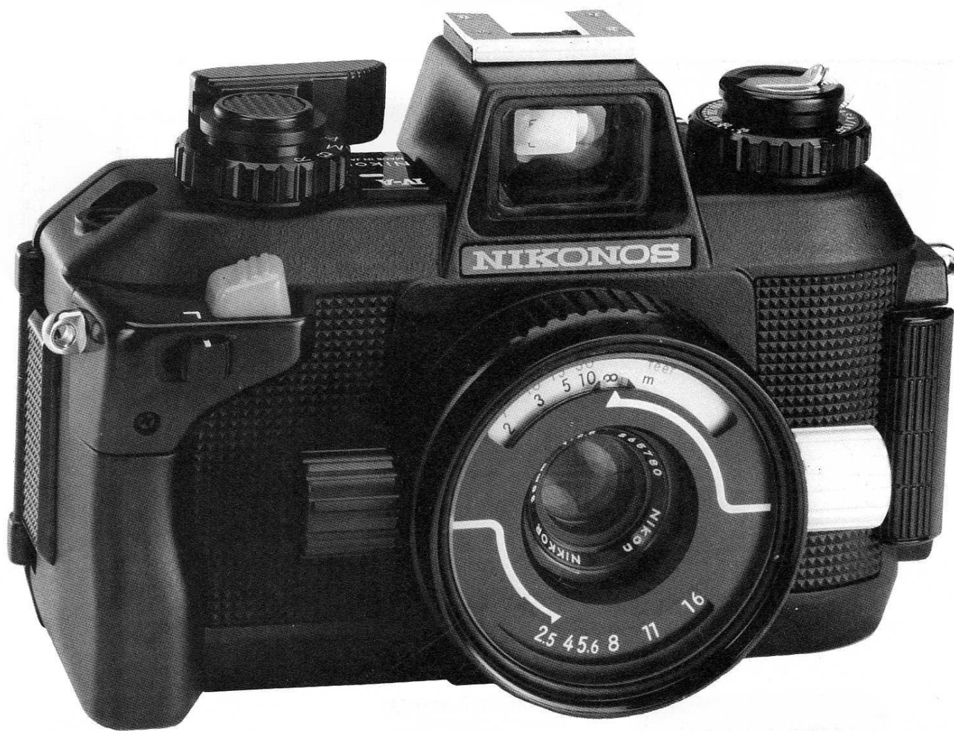
NIKONOS IV : Appareil 24 × 36 pour photo sous-marine. Profondeur maximale 50 mètres. Objectifs interchangeables de la série III. Exposition automatique. Flash automatique en accessoire.
