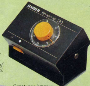
Compte-pose à moteur synchrone de 1/2 à 30", dispositif de répétition, déclenchement par poussoir, puissance de coupure 6 A.
