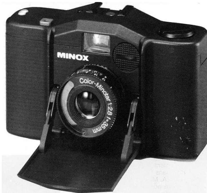
Minox 35 EL. Le plus petit 24 x 36 du monde : il mesure environ 3 x 6 x 10 cm et pèse 190 g. Ses caractéristiques n'en sont pas moins complètes : objectif à 4 lentilles f:2,8 de 35 mm, obturateur électronique à vitesse variable en progression constante de 1/500 s à 30 s.
